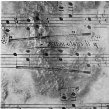
Abb. 90. Notendruckplatte mit Zinnpest. Zinngehalt nach planimetrischer Auswertung 75%.
