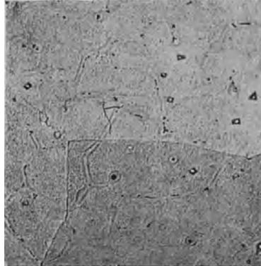
Abb. 73. 0,10% Te. Guß. Würfelförmige Primärkristalle von PbTe. Bleimischkristall mit verästelter Kristallseigerung. 500:1.
