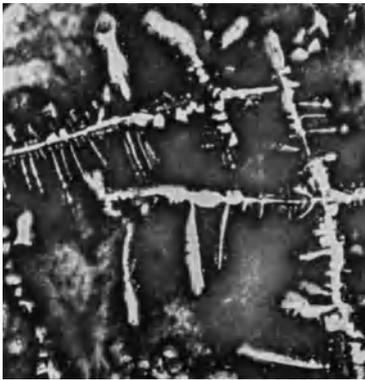
Abb. 62. 5% Ni. Guß. Weiße Primärkristalle von Nickel aus weicher Grundmasse von Blei hervorstechend. 300:1.
