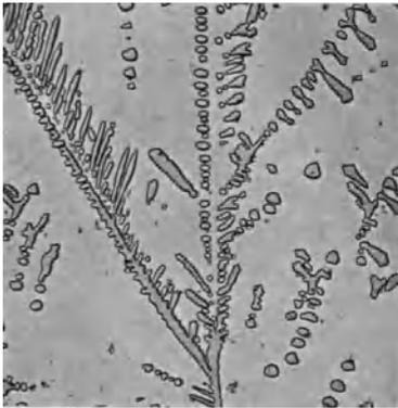
Abb. 225. Bahnmetall. Zusammensetzung s. Zahlentafel 23. Tannenbaumkristalle  $\text{CaP}_3$ . Bleimischkristall. 100 : 1.
