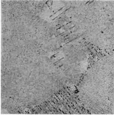
Abb. 83. Einwaage 0,2% Zn. Im Tiegel erstarrt. Bleimischkristall, Eutektikum Blei-Zink, 500:1.
