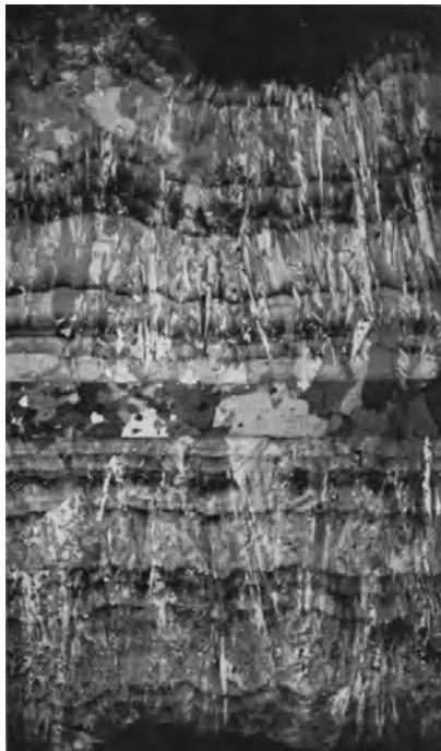
Abb 274. Elektrolytblei. Schnitt durch eine Bleikathode. Einzelne Zonen parallel dem Mutterblech. Stengelkristalle in Stromrichtung. 6 : 1.
