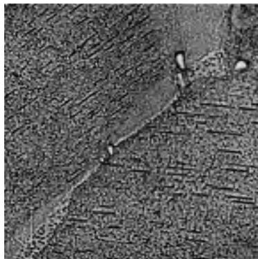
Abb. 185. Bleirohr mit 0,95 % Sb nach dreijährigem Lagern. Gerichtete Ausscheidungen von Antimon. Grobe Entmischung der festen Lösung an den Korngrenzen. 1200:1.
