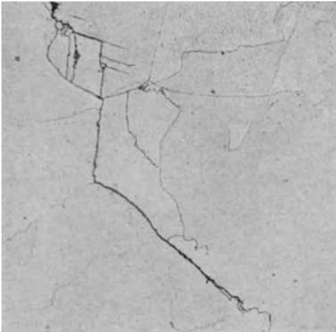
Abb. 183. 0,07% Ca. Auf Planbiegemaschine gebrochener Stab der ausgehärteten Legierung (255). Risse auch im Korninneren. 50:1.
