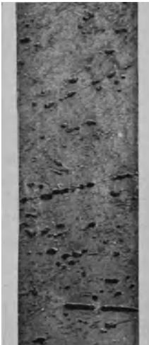
Abb. 194. Bleiblech mit Lochfraß. Boden eines Behälters, in dem Fette mit Schwefelsäure verseift wurden. 0,5:1.
