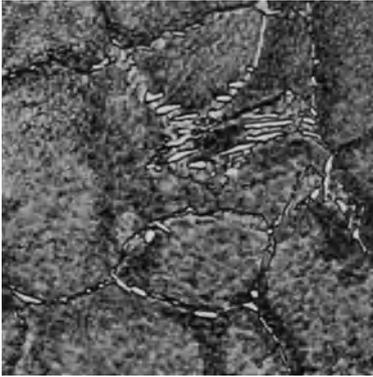
Abb. 6. 2% Sb.Guß. Bleimischkristalle mit Ausscheidungen im festen Zustand. Eutektikum an den Korngrenzen und in den dunkler geätzten Restfeldern. 1500:1.
