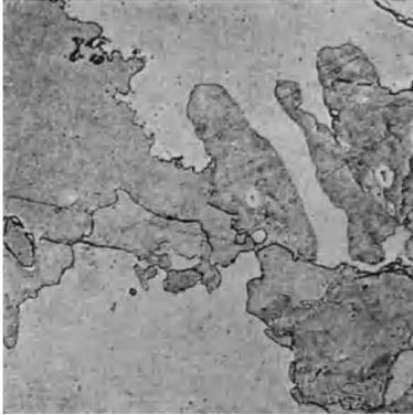
Abb. 46. 0,096% Ca. Guß nach 1 $\frac{1}{2}$ jährigem Lagern. Dunkle Stellen zeigen in höherem Abbildungsmaßstab einzelne Ausscheidungen von CaPb<sub>3</sub>. 150:1.
