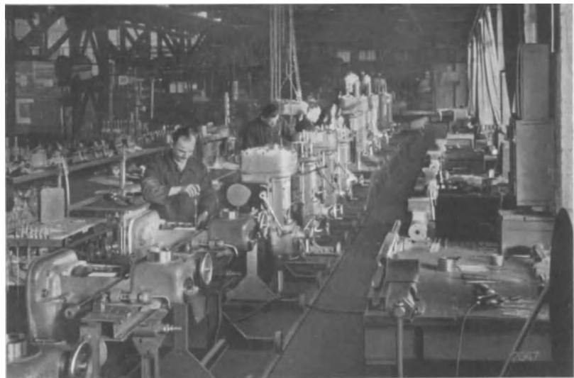
*Bild 916: Der Bohrschlittenkörper wird zum Einbau der Teile und Einheiten auf einem besonderen um 90° schwenkbaren Bock festgespannt. Darauf wandert er im Takt von der ersten Schlossergruppe bis zur vierten und weiter auf den Prüfstand [im Hintergrund sichtbar als erhöhte Rampe]. Dort wird das richtige Zusammenarbeiten aller Teile und Einheiten festgestellt.*
