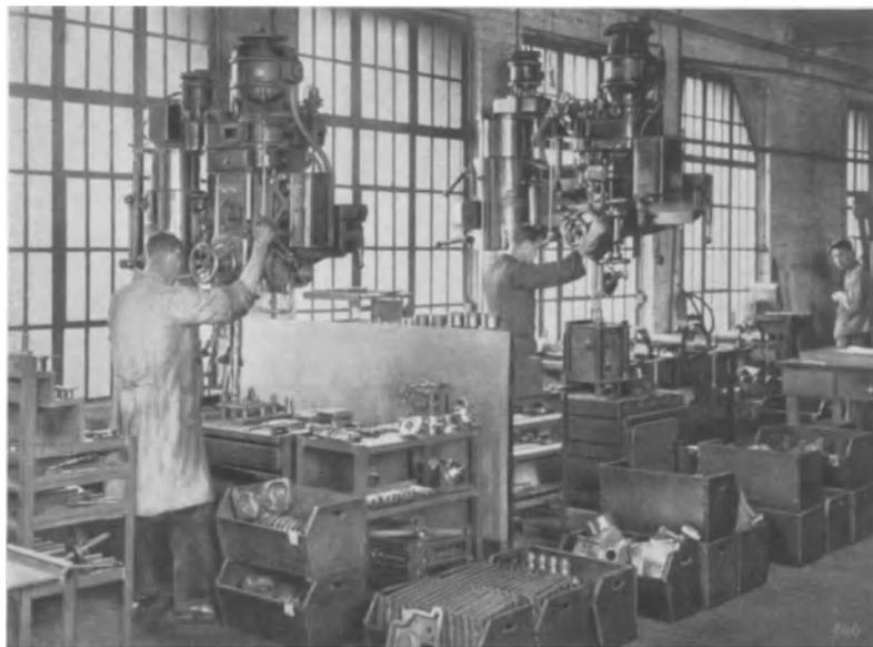
*Bild 412: Radialbohrmaschinen in der Kleinteilfertigung*
