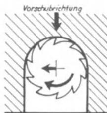
3. Das Verhalten des Fräsers beim Fräsen ins Volle. Der Fräser schneidet am halben Umfang, auf der anderen Hälfte ist er unbelastet. Durch den einseitigen Schnittwiderstand schwenkt er in Pfeilrichtung ab. Die Vorschubrichtung wird also immer quer zum Auslegerprisma eingestellt, damit nicht durch das Abdrücken des Fräsers der Ausleger beiseite geschwenkt wird.
