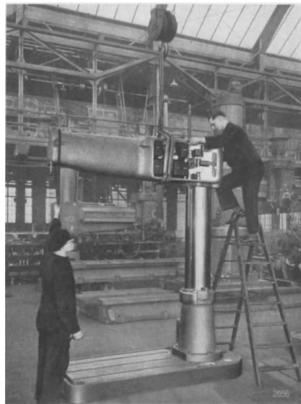
*Bild 914: Das Maschinengestell ist aus Grundplatte, Ständer, Ausleger und Windwerk zusammengesetzt. Die Abbildung zeigt das Aufziehen des Auslegers auf dem Ständer, Die Ausleger-Einheit ist zum Anbau des Windwerkes fertiggestellt. Auch die elektrische Ausrüstung ist schon in der Kammer eingebaut und braucht später, wenn die Maschine den Zusammenbau verläßt, nur noch angeschlossen zu werden.*
