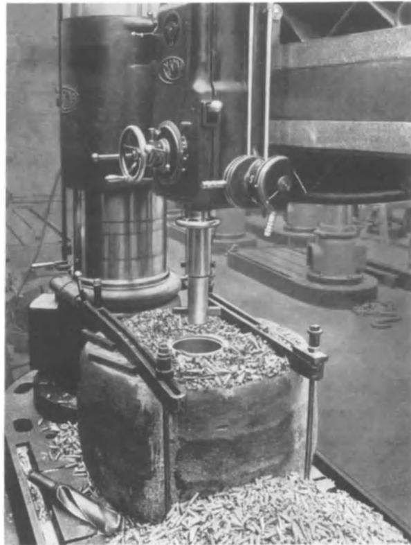
Bild 411: Radialbohrmaschine beim Bohren eines schweren Stahlkörpers
