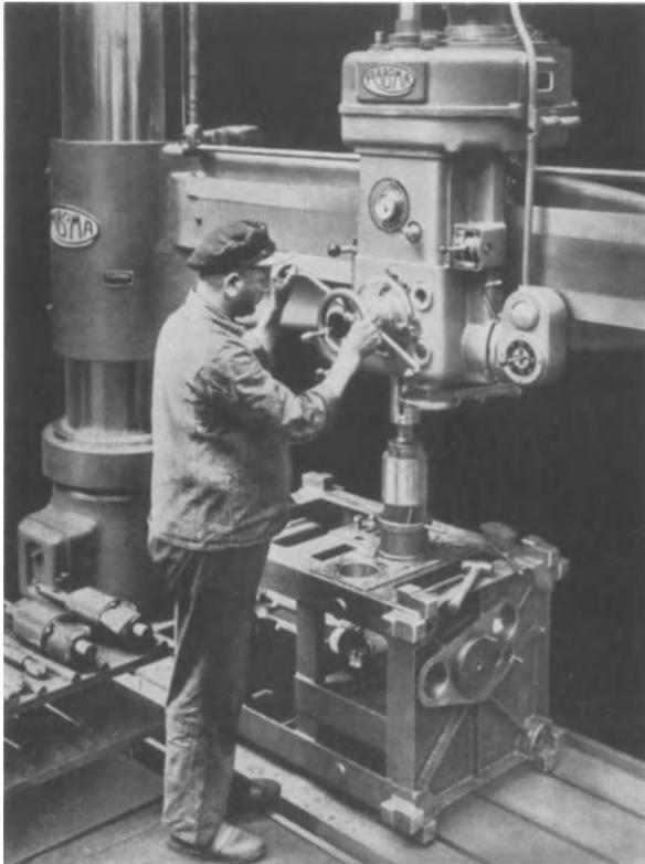
*Bild 403: Bohrvorrichtung mit einseitig geführtem Werkzeug (Oberführung)*
