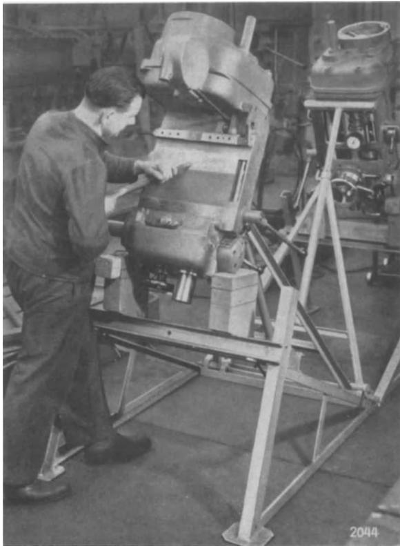
*Bild 915: Baugruppen sind unter anderen das Aufsetzen und Einfahren des Windwerkes, oder das Aufschaben des Bohrschlittens. Für letztere Arbeit ist wieder ein besonderer Bock vorhanden, der die Aufgabe wesentlich erleichtert.*
