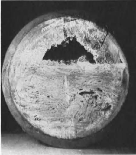
Abb. 6. Kalksinter in einer Rohrleitung (durchgeschnitten).
