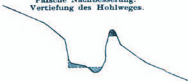
Fig. 8. Falsche Nachbesserung: Vertiefung des Hohlweges.
