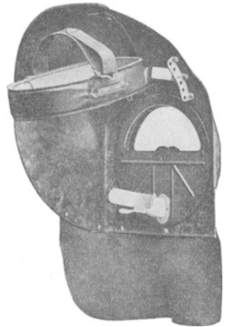
Abb. 158. Schutzhaube für Elektroschweißer.
