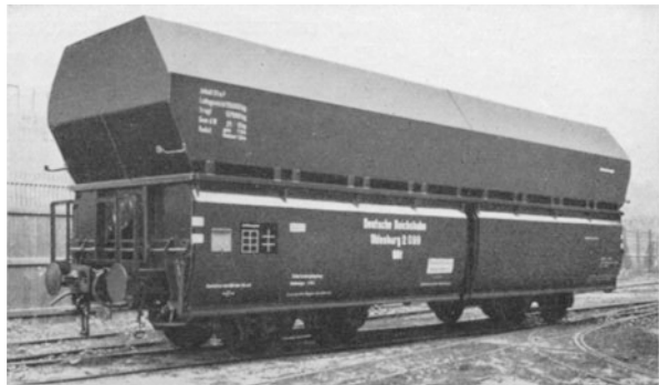
Abb. 263. Vollkommen geschweißter Großraum-Sattelwagen (Si-Stahl).
