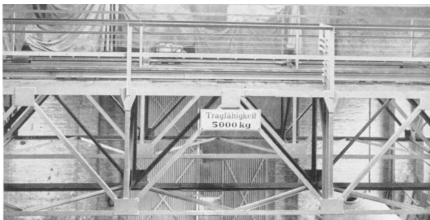
Abb. 279. Fachwerk eines geschweißten 5-t-Krans.
