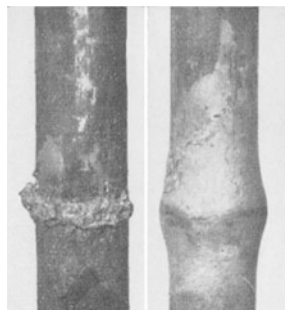
Abb. 56. Wulst beim Stumpf- und Abschmelzschweißen.
