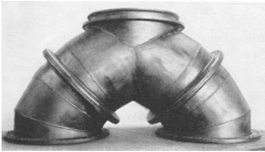
Abb. 207. Elektrisch geschweißtes Hosenrohr.
