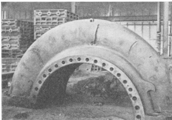
Abb. 300. Oberteil eines Spiralpumpengehäuses vor der Schweißung.
