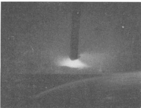
Abb. 97. Lichtbogen zwischen Eisen und Eisen.
