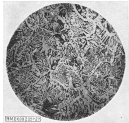
Abb. 353. Gefüge der Schweißstelle (Abschmelzschweißung) (V = 67).
