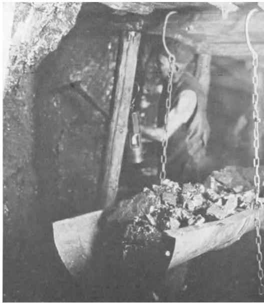
Abb. 15. Kohलगewinnung mit der Hacke. Schüttelrutsche. Benzinhandlampe.
