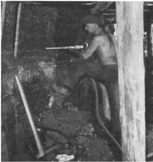
Abb. 9. Kohlegewinnung mit dem Abbauhämmer. Man sieht besonders schön, wie die Kohle, in der der Hauer arbeitet, viel dunkler ist in der Aufnahme als das darunter liegende Gestein.
