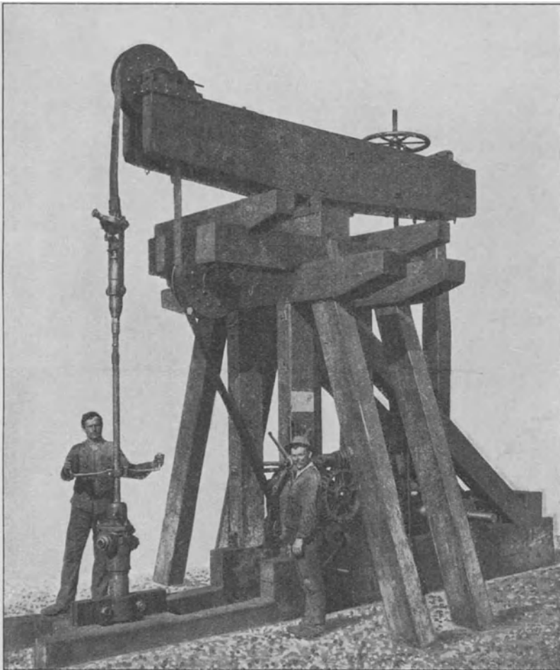
Fig. 239 a. Express-Dampfbohrkran, Type I, II, III zum Herstellen von Bohrlöchern bis auf 1500, 1000 und 500 m Tiefe.
