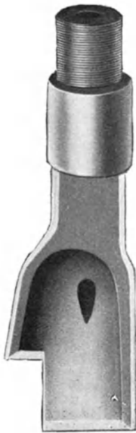
Fig. 25. Spülmeißel mit Fortsatz- schneide von Deseniss & Jacobi A.-G.
