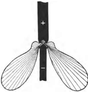
Fig. 234. Lichtverteilung eines Gleichstromlichtbogens
