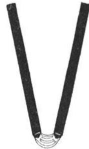
Fig. 239 Lichtbogen bei schräg nebeneinander angeordneter Kohlen
