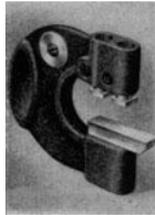
Abb. 19a und b. Verstellbare Grenzachsenlehre (Bauart Reindl & Nieberding).
