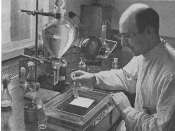
Ein Tropfen von Zaponlack ist auf Wasser getropft worden und hat sich zu einer sehr feinen Haut verteilt. Gerade soll der Objektträger unter die Zaponhaut geschoben werden, so daß beim Herausheben der Trägerplatte alle 8 Plättchen, die in der Mitte eine feine Öffnung tragen, mit dem Häutchen überzogen sind.
