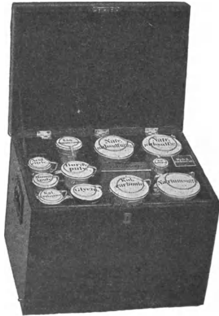
Bild 234. Feldröntgenwagen, Kasten mit chemischen Röntgenstoffen.
