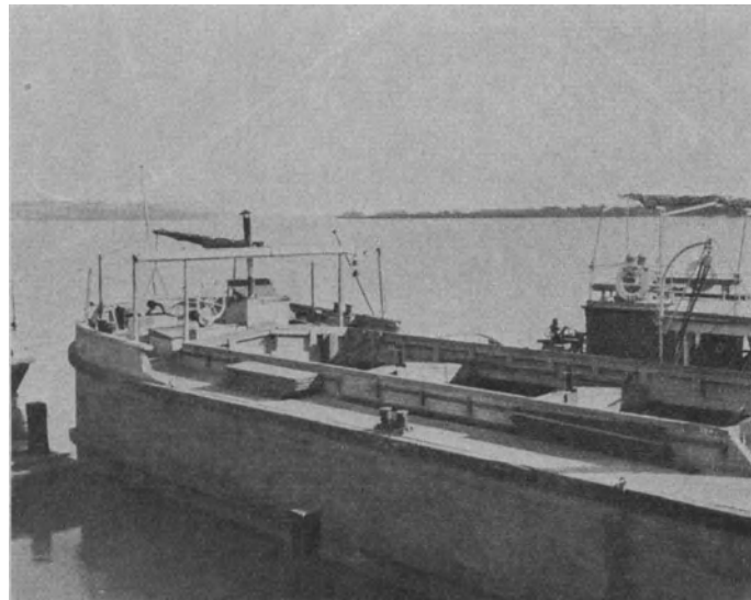
Abb. 40. Bagerschute aus Eisenbeton in Paraná.
