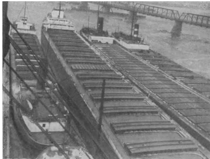
Abb. 96. Seenfrachtdampfer, verschiedene Lukenausbildung.
