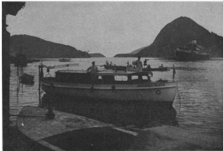
Abb. 44. Von Deutz 1922 geliefertes Motorboot (12 × 2,5 × 0,85 m) mit 45-PS-Benzinmotor für die Zollverwaltung von Victorio (Staat Espirito Santo), 10 Knoten.
