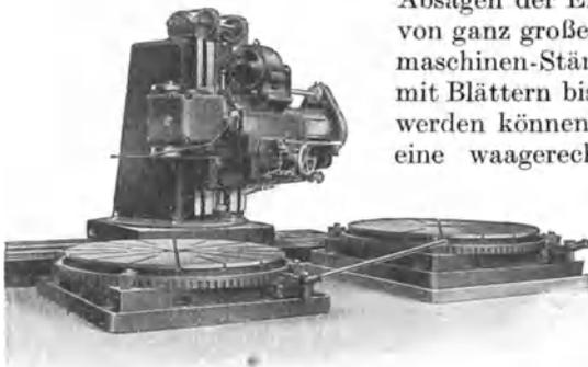
Abb. 49. Große Kalkkreissäge mit 2 Aufspanntischen.
