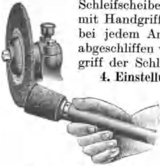
Abb. 63. Abrichtapparat.
