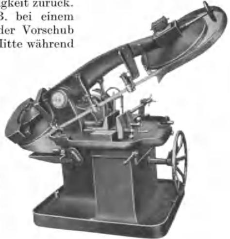
Abb. 96. Horizontale amer. Metallbandsäge.
