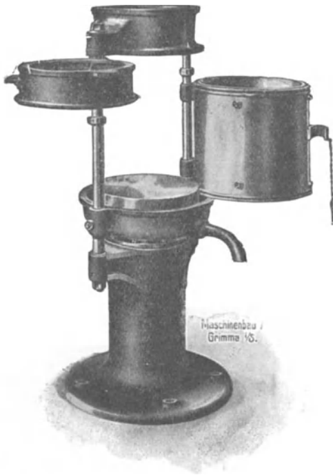
Abb. 329. Mit Wasserleitungsdruck betriebene Grieben- presse. (Maschinenfabrik Golzern, Grimma i. S.)
