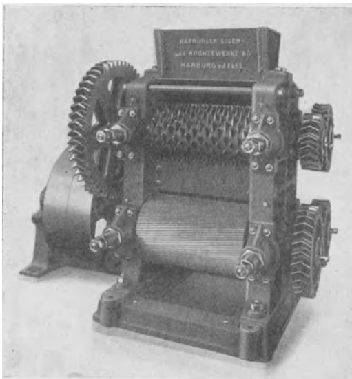
Abb. 287. Kuchenbrecher mit Stachel- und Riffelwalzen (Räderschutz entfernt).
