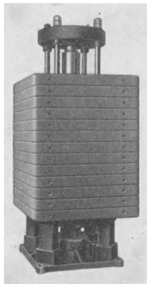
Abb. 184. Akkumulator mit Belastungsplatten aus Gußeisen. (Friedr. Krupp-Grusonwerk A. G., Magdeburg-Buckau.)
