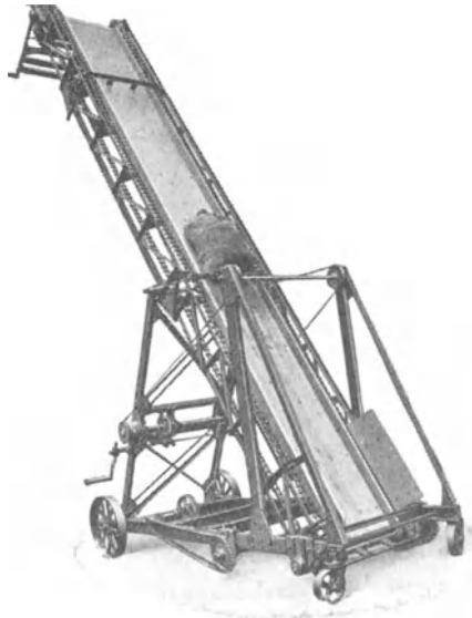
Abb. 55. Fahrbarer Sackstapler mit veränderlicher Neigung. (G. F. Lieder G. m. b. H., Wurzen i. Sa.)
