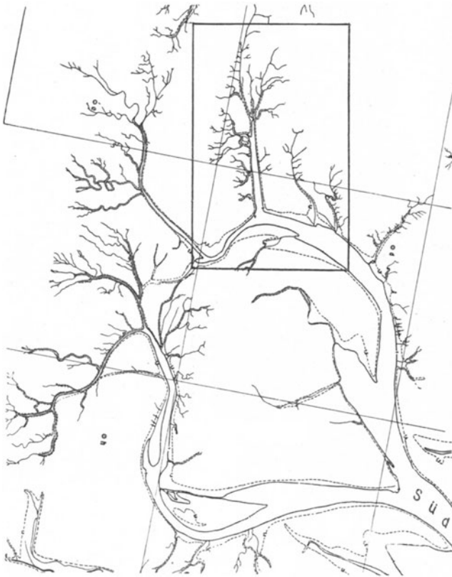
Abb. 5. Topographie im Flachlande. Ausschnitt aus einer Aufnahme des Wattengebietes bei Wangerooge durch einfache Luft-Meßbilder, ausgeführt von dem Reichsamt für Landesaufnahme in Berlin SW 68, Lindenstr. 37. Quadratseite = 1000 m.
