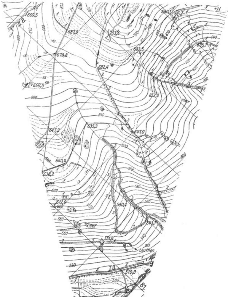
Abb. 3. Topographie im Mittelgebirge. Stereoskopische Aufnahme auf der Erde des Reichsamts für Landesaufnahme in Berlin SW 68, Lindenstr. 37. Maßstab des Originals 1 : 5000. Abstand der Schichtlinien = 5 m. Quadratseite = 200 m.
