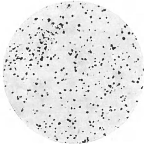
Abb. 49. Entwickeltes Korn der Agfa-Kinepositivfilm-Emulsion. (Vergr. 600fach.) (Bromsilberkorn s. Abb. 185c, S. 282)
