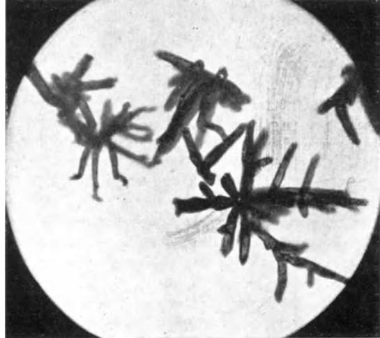
Abb 253c AgCl + Methylenblau (Dendritenbildung)
