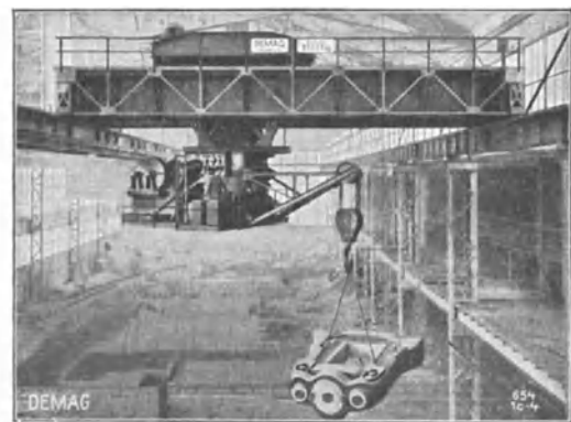
Abb. 28e. Schwenkkatzenlaufkran in einer Stahlgießerei.
