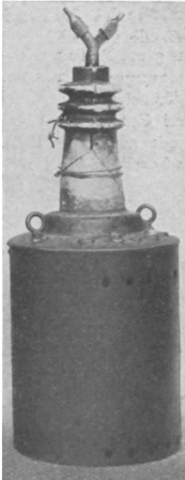
Abb. 2. Durch Kurzschluß gesprengter Stromwandler.
