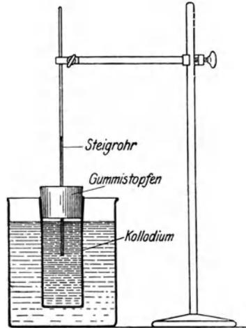
Abb. 8. Einfaches Osmometer.
