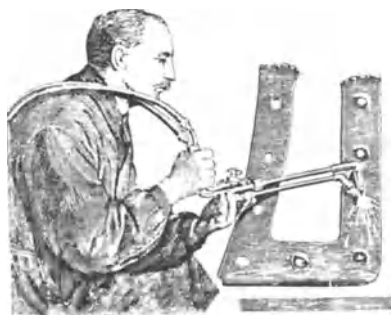
Fig. 139. Zweistrahlbrenner zum Abtrennen von Nietköpfen.
