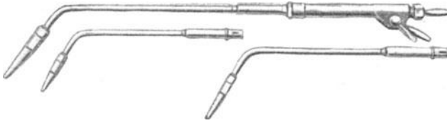
Fig. 122. Schweißbrenner mit auswechselbaren Köpfen.
