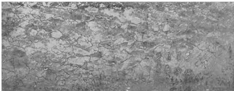
Abb. 19. Netzwerk von Rissen auf der Oberfläche eines Bleches. \times \frac{1}{3}
