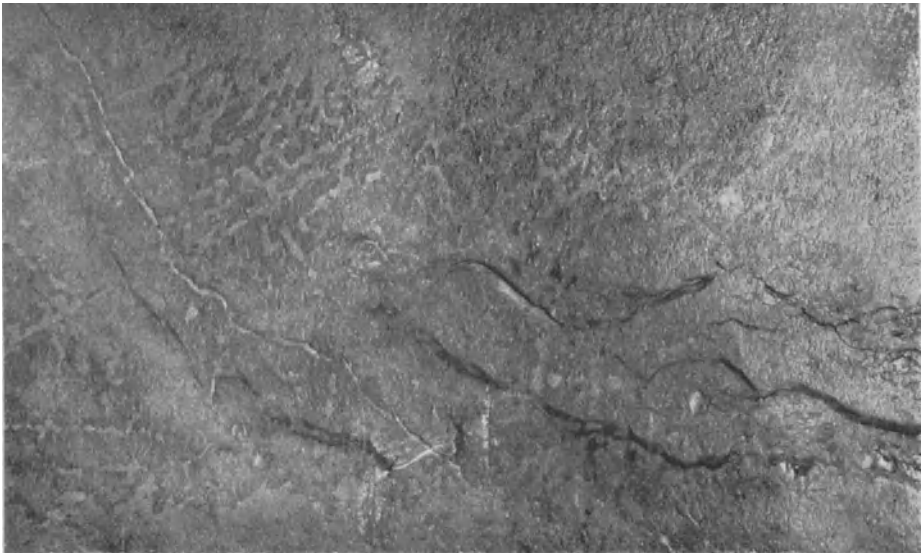
Abb. 18. Oberfläche eines Bleches mit parallelen Schrumpfrissen.
