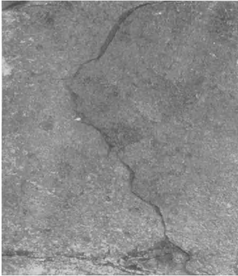
Abb. 16. Oberflächenriß eines Bleches, auf dem Querschnitt (Abb. 13) als Überwalzung zu erkennen.
