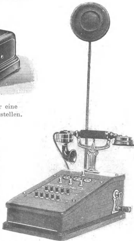
Abb. 48. Tischapparat für drei Amtsleitungen und zehn Nebenstellen mit Vorschaltetasten.
