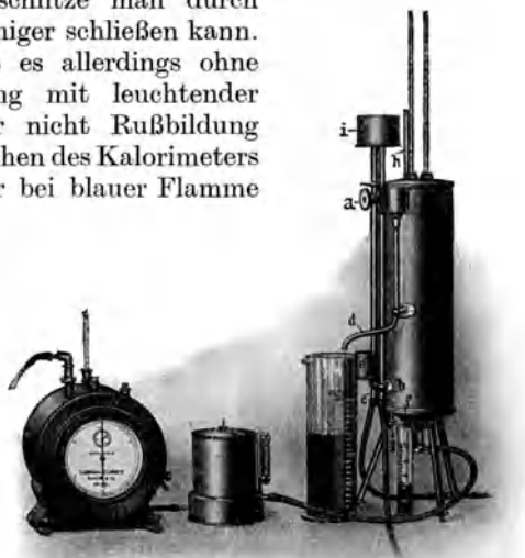
Gasuhr Druckregler Mensur Kalorimeter Mensur Fig. 314. Aufbau des Junkers-Kalorimeters für Gase. Junkers & Co., Dessau.
