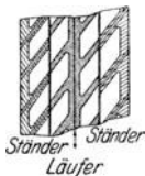
Fig. 190. Tangentialer Schnitt durch die Schaufelung einer um- steuerbaren Froude- bremse.
