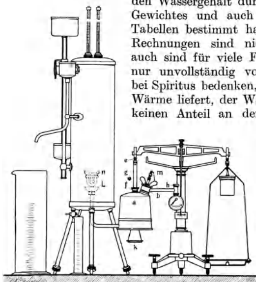
Fig. 315. Aufbau des Junkers-Kalorimeters für flüssigen Brennstoff.
