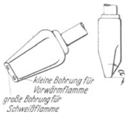
Abb. 89. Normaler Zweiflammnbrenner (für Kantenvorwärmung).
