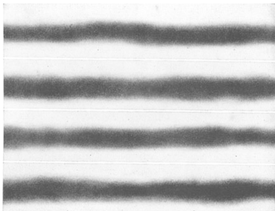
Abb. 319. Röntgenbilder der Längsnaht geschweißter Kessel.
