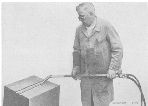
Abb. 304. Schneiden von Kerbrillen an einem Stahlblock mit dem Sauerstoffhobler.
