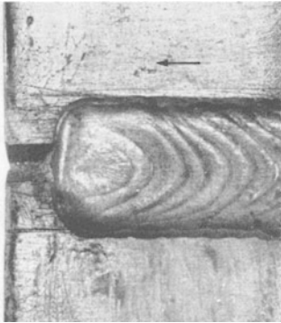
Abb. 243. Liegend geschweißte Stumpfnaht an 5 mm-Bleiblech.
