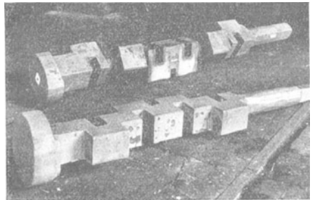
Abb. 297. Schnitte an Kurbelwellen.
