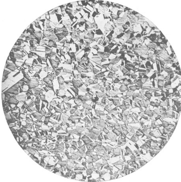
Abb. 331. Kleingefüge von Kupfer, ungeschweißt ( V=115 ).
