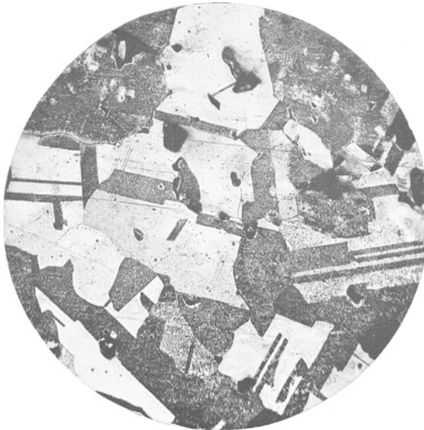
Abb. 332. Grobkristallines Kleingefüge einer unvergüteten Kupferschweißnaht ( V=115 ).
