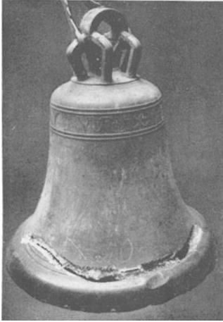
Abb. 241. Bronzene Kirchenglocke, zur Schweißung vorbereitet.
