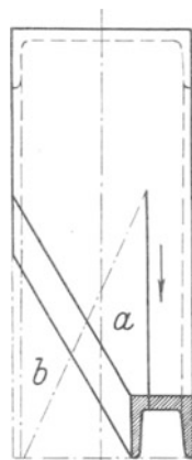
Abb. 194. Verjüngung eines U-Eisens durch Schweißen.
