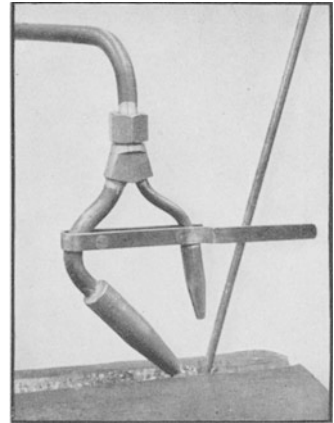
Abb. 88. Zweiflammnbrenner (für Schweißstabvorwärmung).
