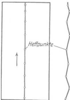
Abb. 123. Werfen der Bleche beim Heften der Naht.
