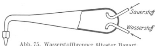
Abb. 75. Wasserstoffbrenner ältester Bauart.
