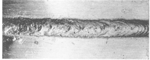
Abb. 237. Fehlerhafte Messingblechnaht (zu geringer Sauerstoffüberschuß).
