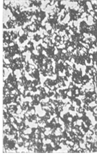
Abb. 15. Stahl mit 0,4 vH Kohlenstoff ( v = 200 ).
