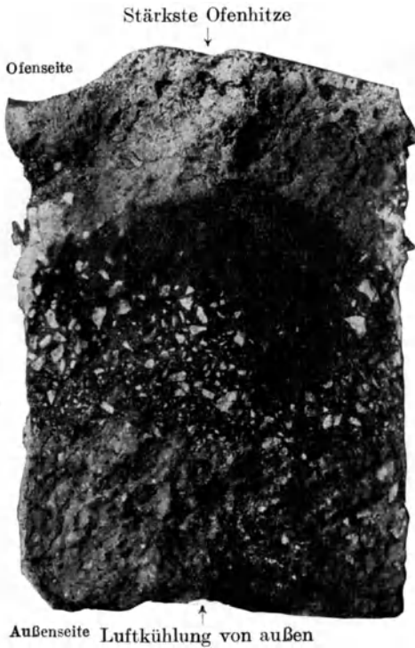
Bild 10 (nach Endell). Quarzkalkstein nach 50 Chargen im Martinofen
