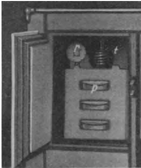
Abb. 43. Anordnung des Verdampfers im Kühlschrank von Kelvinator.
