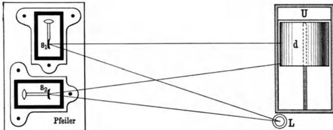
Schematische Darstellung des zweiteiligen v. Hebeur-Chertischen Horizontalpendels nach Bosch.
