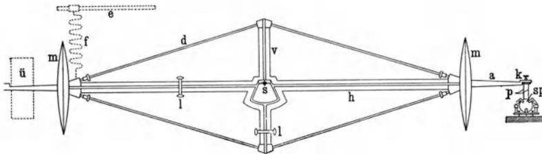
Klinograph nach Schlüter. Ursprünglicher Apparat; die punktiert gezeichneten Teile kommen bei der Umwandlung in das Vertikalfeismometer hinzu.
