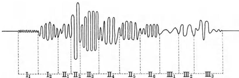
Schematische Darstellung der einzelnen Wellenzüge eines Fernbebenogramms.
