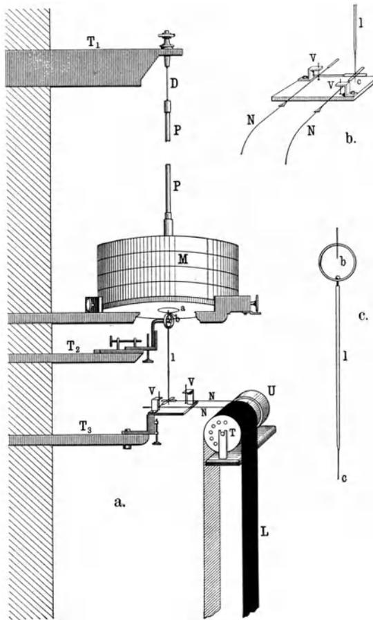
Schematische Darstellung des Seismometers für die Horizontal-Komponente.
