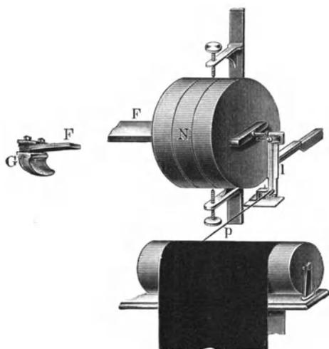
Schematische Darstellung des Seismometers für die Vertikal-Komponente.
