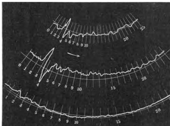
Registrierung des Tokyo-Behens vom 20. Juni 1894; oben die SE-NW-Komponente, in der Mitte die NE-SW-Komponente, unten die vertikale Komponente.
