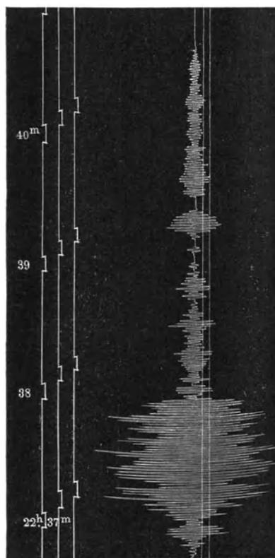
Registrierung eines Fernbebens (Horizontalkomponente) mittels des Vicensinischen Mikroseismographen
