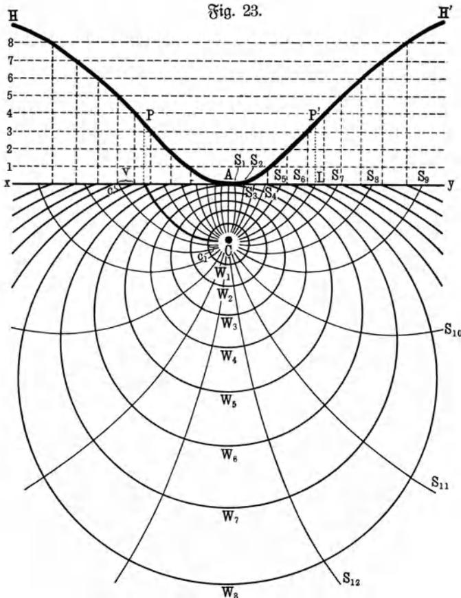
Schematische Darstellung von Stoßstrahlen und Hodograph. Nach A. Schmidt.
