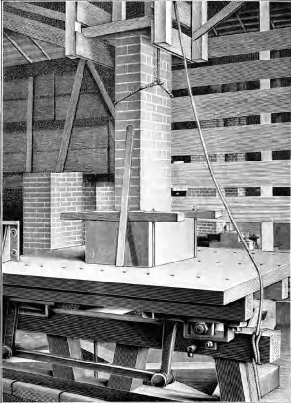
Apparat für künstliche Erdbeben mit zum Versuch aufgesetztem Backsteinpfeiler.
