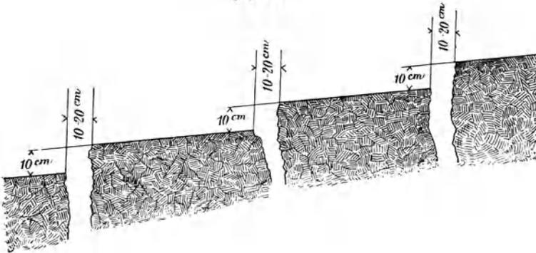
Schnitt durch parallele, mit Sentungen verbundene Bodenspalten. Nach H. Faidiga.
