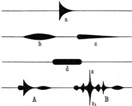
Typische Störungsfiguren. *a* Ausschwingung. *b, d* Anschwemmung. *c* Ausbauchung. *A* Normalstörung. *B* kombinierte Normalstörung mit Stoßmaximum *s s<sub>1</sub>*.
