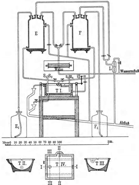
Vorrichtung zum Entwickeln und Fixieren von Photogrammen. Nach A. Schütt.
