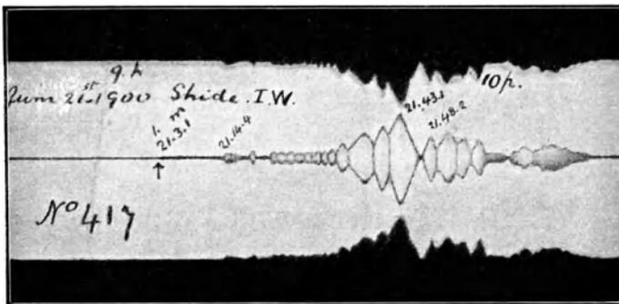
Photogramm eines Fernpendels mittels Milne's Horizontalpendels.
