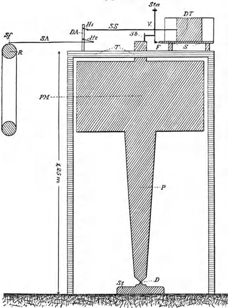
Schematische Darstellung des Wiechert'schen astatischen Pendelseismometers.
