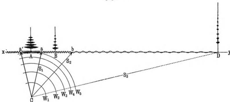
Schematische Darstellung der verschiedenen durch ein Erdbeben hervorgerufenen Bewegungsarten. Nach A. Delar.
