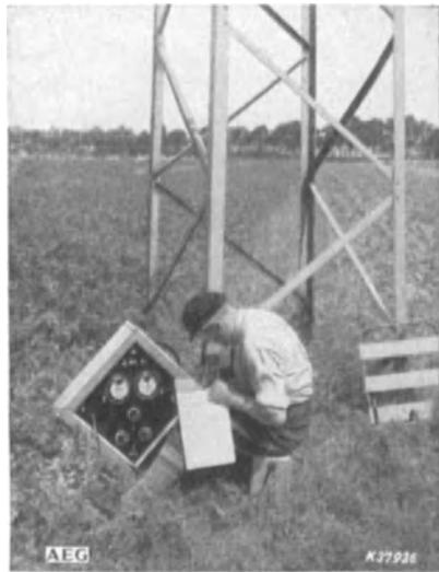
Abb. 484. Hochspannungsfehlersucher.
