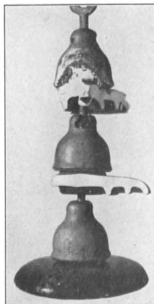
Abb. 481. Durch den Erdschlußlichtbogen beschädigte Kappenisolatoren.
