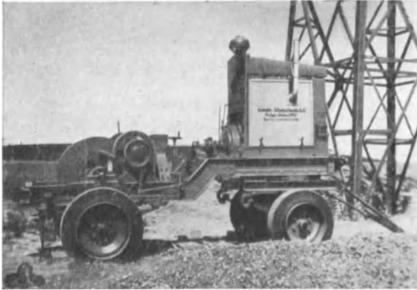
Abb. 456. Seilzugwinde.
