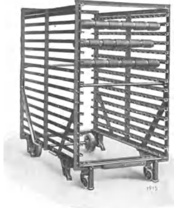
Abb. 6. Transportwagen für Spulen.
