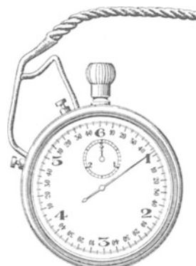
Abb. 39. Diese auf \frac{1}{100} Sekunde ablesbare Stoppuhr schließt einen Stromkreis während der Laufzeit ihres Zeigers. Sie ermöglicht die bequeme Herstellung bekannter Amperesekunden. Ein kaum weniger bequemer Zeitschalter kann leicht mittels eines Grammophonuhrwerkes improvisiert werden.
