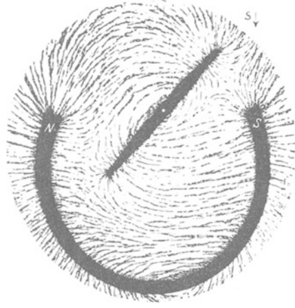
Abb. 2. Magnetische Feldlinien. Der Hufeisenmagnet NS dreht die Kompaßnadel gegen den Uhrzeiger.
