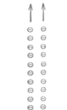
Abb. 190. Zwei parallel zueinander fliegende Reihen von Elektrizitätsatomen gleichen Vorzeichens.
