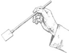
Abb. 52. „Löffel am Bernsteinstiel“, kleiner „Konduktor“ oder „Elektrizitätsträger“.
