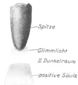
Abb. 335. Der Spitzenstrom in Zimmerluft bei mikroskopischer Beobachtung.
