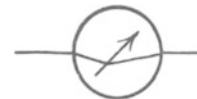
Abb. 22. Zeichenschema eines Hitzdrahtstrommessers. Wird späterhin auch bei solchen Hitzdrahtstrommessern angewandt, die als Spannungsmesser oder Voltmeter umgeiecht sind.
