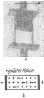
Abb. 378 a u. b. Sichtbare Elektronen-Überschußleitung in einem KBr-Kristall.
