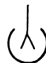
Abb. 29. Zeichenschema eines „statischen Spannungsmessers“, „statischen Voltmeters“ oder „Elektrometers“. Ohne Eichung auch „Elektroskop“ genannt.
