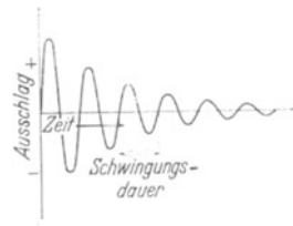
Abb. 288. Graphische Darstellung einer gedämpften Schwingung. Das Verhältnis zweier aufeinanderfolgender Amplituden (Höchstauschläge) heißt das Dämpfungsverhältnis. Dessen natürlicher Logarithmus wird logarithmisches Dekrement genannt.
