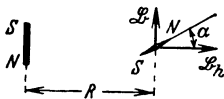
Abb. 209. Messung der Kraftflußdichte \mathfrak{B} eines Dipolfeldes in der „zweiten Hauptlage“ durch Vergleich mit der bekannten Kraftflußdichte des horizontalen Erdfeldes \mathfrak{B}_h = 0,2 \cdot 10^{-4} Voltsek./m 2 .
