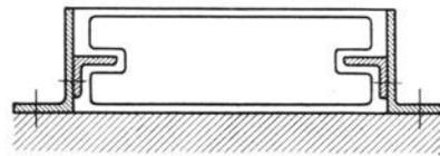
Abb. 36. Führung des Gegengewichtes durch in Einschnitte des Gewichtskörpers eingreifende Schienen.
