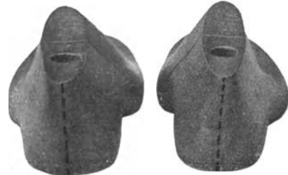
Abb. 14. Neuer ausgesprochener Varusleisten von der Rückseite betrachtet.
