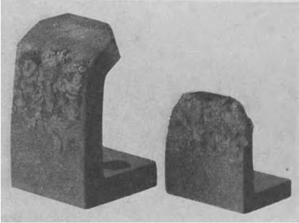
Abb. 1. Kontakte von Regulierschaltern nach längerem Betrieb.
