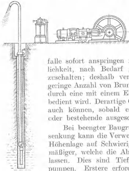
Abb. 48. Mammutpumpe mit Luftdruck- erzeugungsmaschine.
