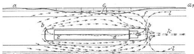
Abb. 12. Strömungen und Einsenkungen, beobachtet an einem Selbstfahrer.
