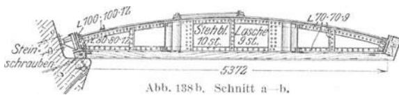
Abb. 138. Eisernes Stemmtor der Schleuse bei Wernsdorf. (Oder-Spree-Kanal.)
