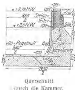
Abb. 77. Schleuse bei Gr.-Tränke.
