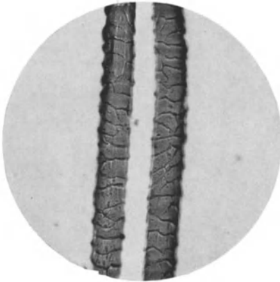
Bild 3. Wolle, Längsansicht. 300fach. Neocarmin
