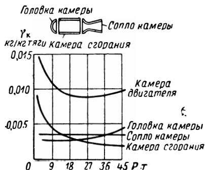
Фиг. 7. 22. Изменение удельного веса камеры двигателя в зависимости от величины тяги.
