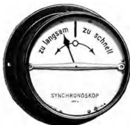
Abb. 60. Skala eines elektrodynamischen Synchronoskops.
