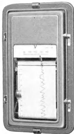
Abb. 99. Tintenschreiber von S. & H. für Schalttafel einbau.
