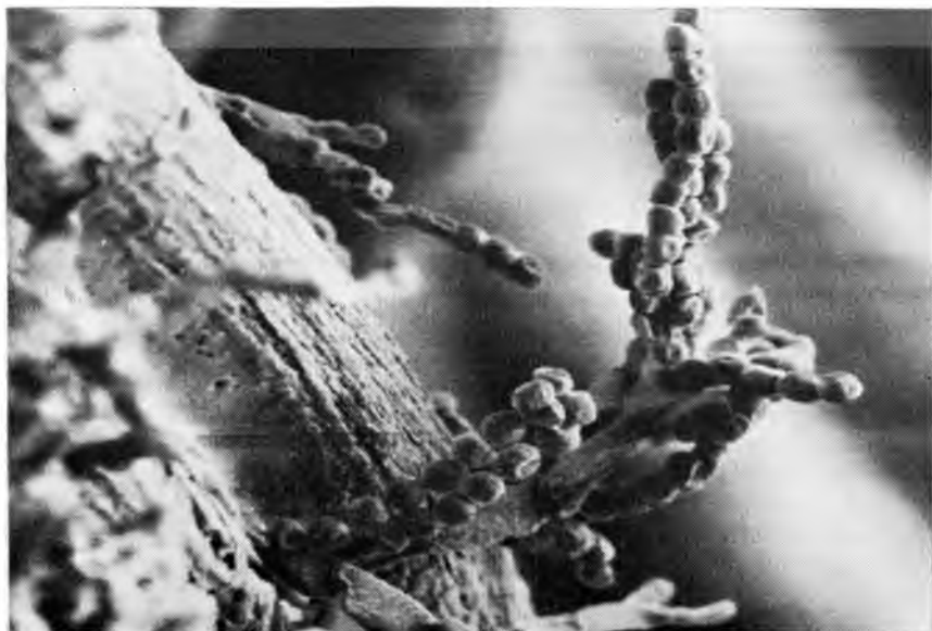
Рис. 155. Pycnostysanus azaleae на ленте эластичной из полиимида (общий вид, увел. 1000)
