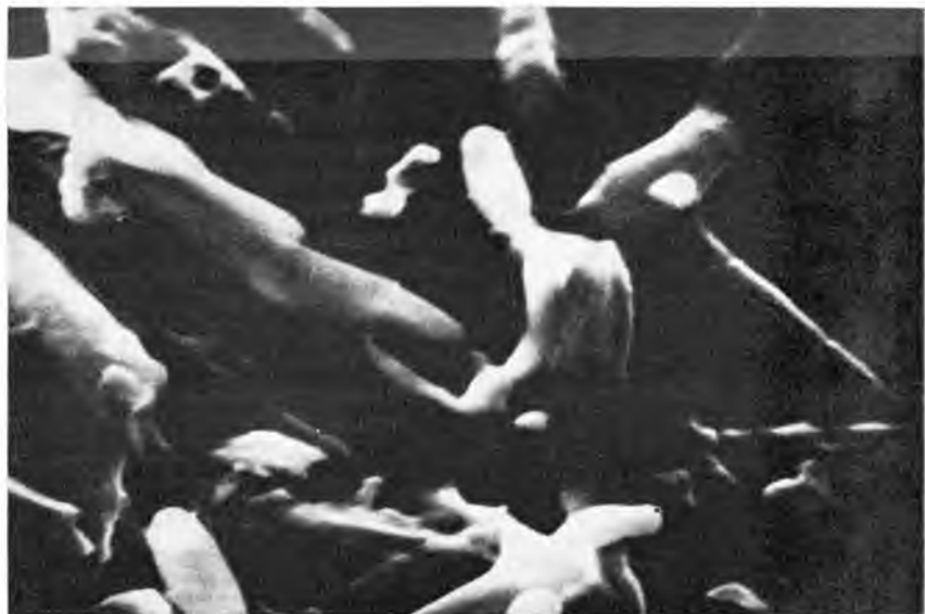
Рис. 72. Dendryphiella salina на текстилите (общий вид, увел. 1000)
