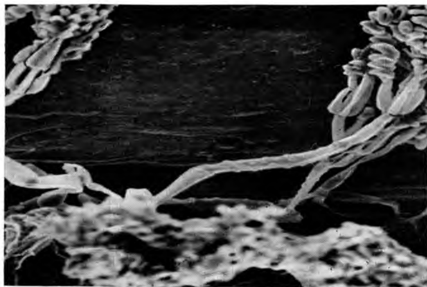
Рис. 117. Myrothecium roridum на полиэтиленовой пленке (общий вид, увел. 600)
