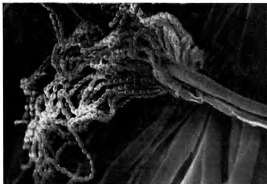
Рис. 136. Penicillium palitans на полотне капроновом (общий вид конидиальных органов, увел. 700)
