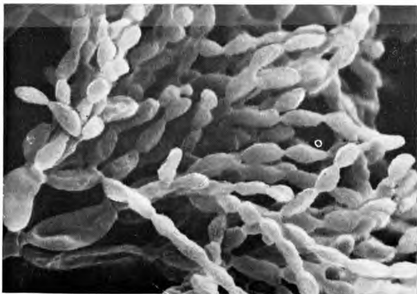
Рис. 63. Cladosporium herbarum на сплаве (общий вид конидиальных органов, увел. 800)
