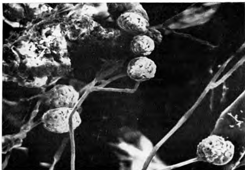
Рис. 113. Mucor hiemalis на пленке из фторопласта (общий вид, увел. 600)
