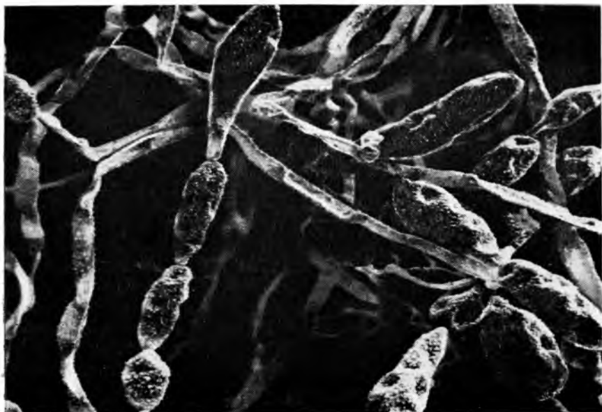
Рис. 12. Alternaria alternata на материале из полиамида (общий вид, увел. 750).
