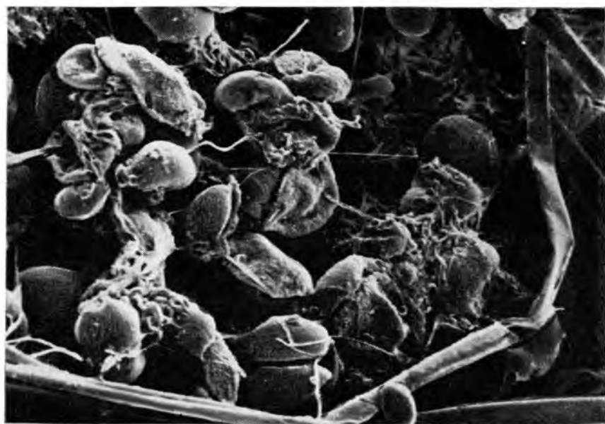
Рис. 94. Gonatobotrys simplex на ткани стеклянной (общий вид, увел. 300)
