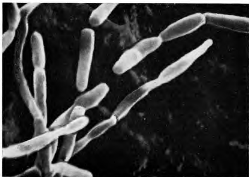
Рис. 100. Heteroconium tetracoilum на термоусаживающейся трубке (общий вид конидиальных органов, увел. 5000)
