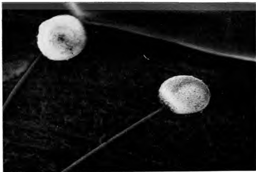
Рис. 111. Mucor circinelloides на изоляционной ткани из стеклянных комплексных нитей (общий вид спороношения, увел. 500)
