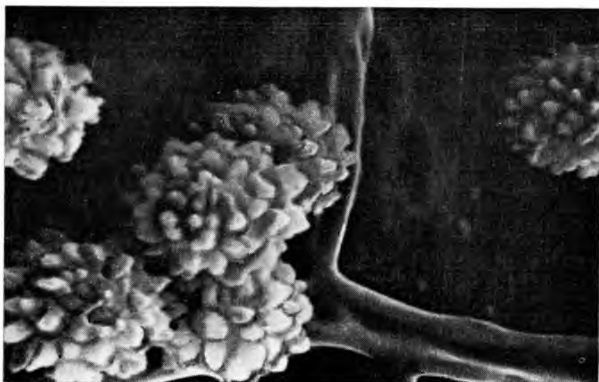
Рис. 39. Aspergillus sydowii на ткани прорезиненной (общий вид, увел. 7800)
