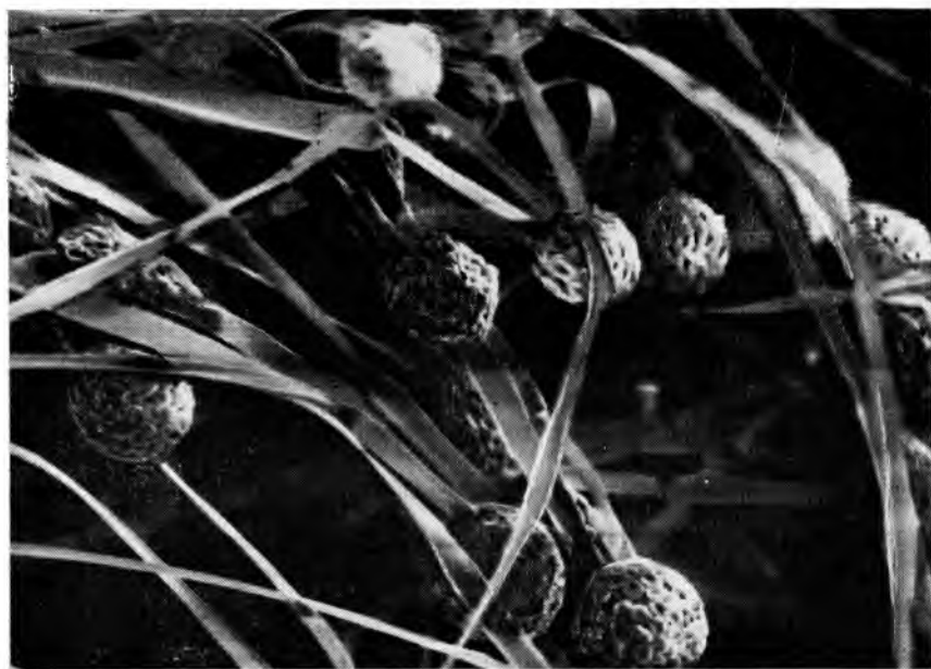
Рис. 110. Mortierella polycephala на углепластике (общий вид, увел. 700)
