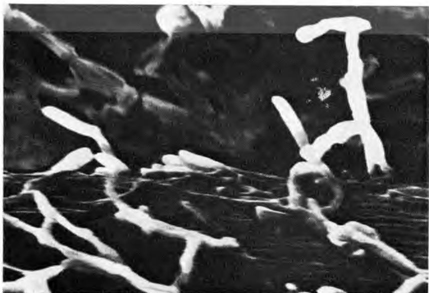
Рис. 79. Endophragma alternata на ткани резинотехнической (общий вид, увел. 2000)
