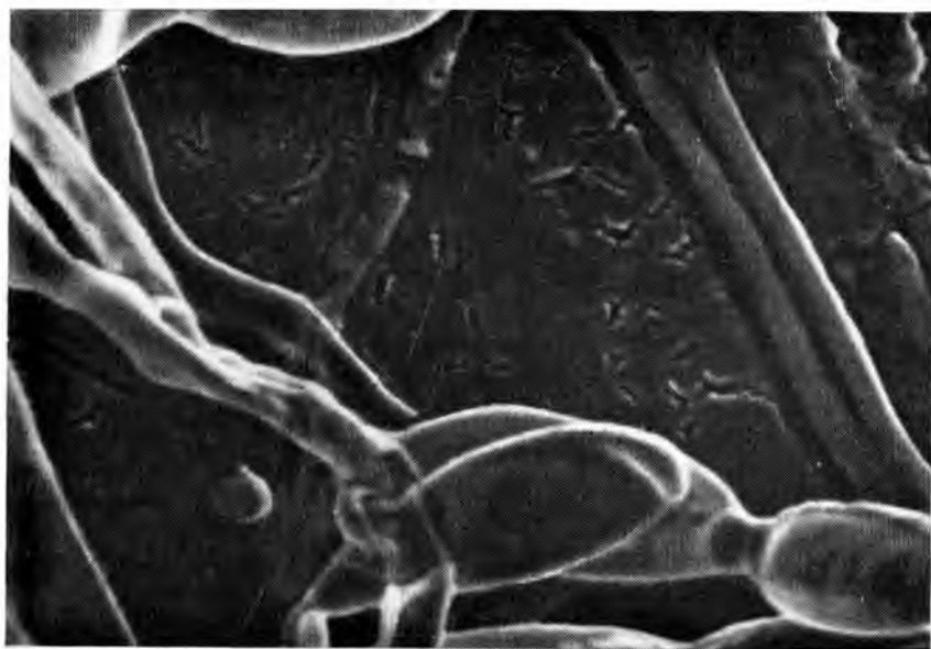
Рис. 20. Amblyosporium botrylis на ленточном кабеле (увел. 3000)
