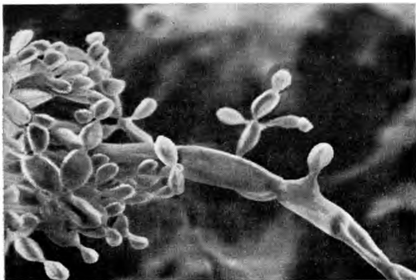
Рис. 47. Botryosporium longibrachiatum на пленке поливинилхлоридной пластифицированной (фрагменты конидиальных органов, увел. 1500)
