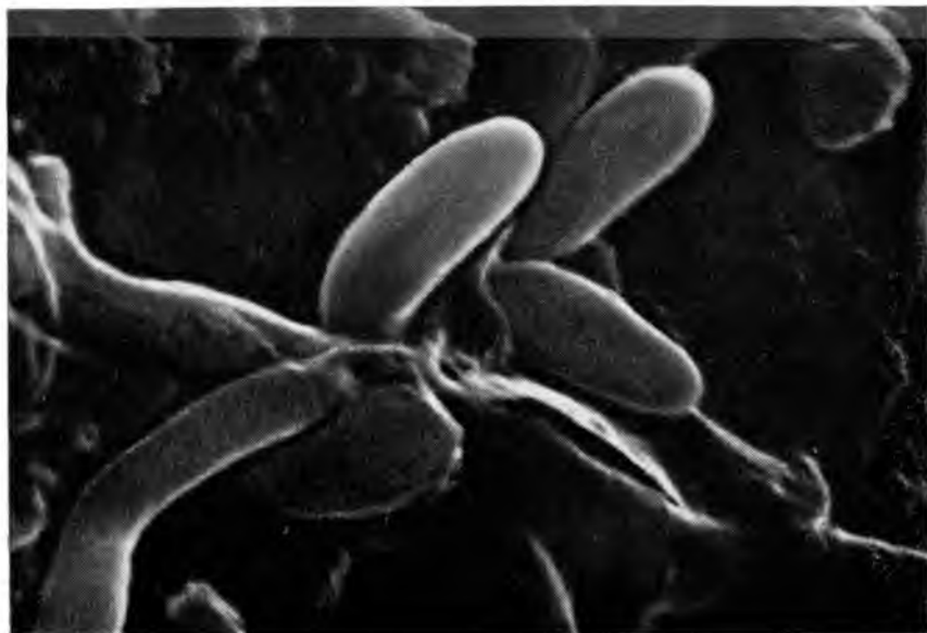
Рис. 99. Helminthosporium solani на поливинилхлоридной пленке (общий вид, увел. 2000)
