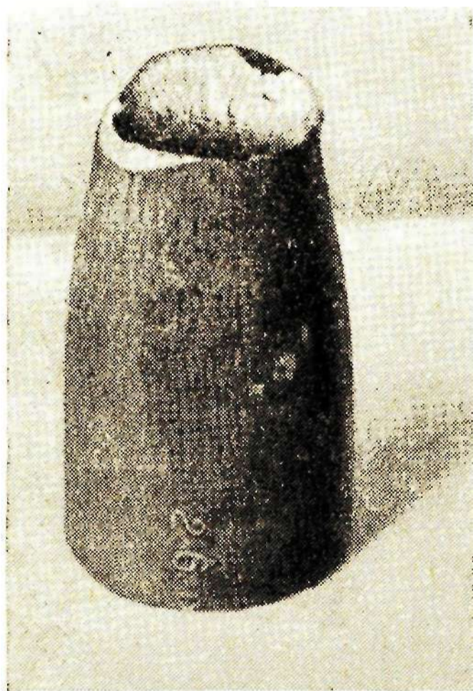
Рис. 11.10. Разрыв круглого стального стержня
