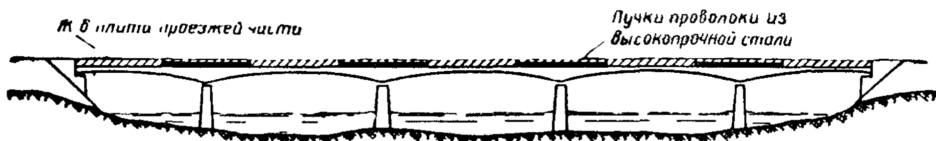
Рис. VIII.53. Схема пролетного строения моста с неразрезной предварительно напряженной балкой переменного сечения
