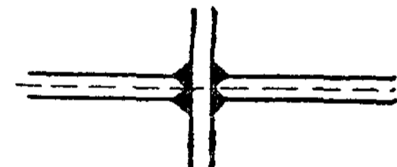
Рис V.17. Стык через прокладку с разделкой кромок
