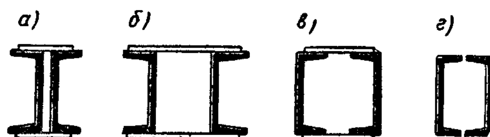
Рис. IV.3. Типы составных сечений из швеллеров
