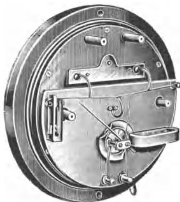
Abb. 539. Hitzdraht-Strommesser von Hartmann & Braun.
