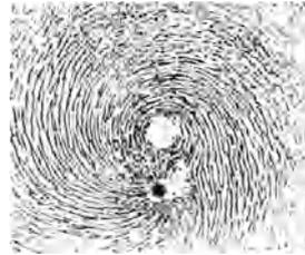
Abb. 88. Magnetisches Feld eines Stromes und eines Magnetpols.
