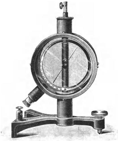
Abb. 30. Elektrometer nach Braun.
