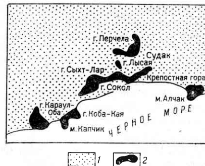
Рис. 33. Схема расположения рифовых массивов в окрестностях Судака 1 — средние и верхнеюрские песчаники, глины и слоистые известняки; 2 — рифовые массивы неслоистых известняков.
