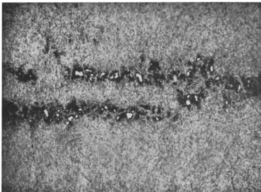
Bild 26. Mikrophotographische Aufnahme einer Glimmstelle (Vergrößerung 1:10) bei durchfallendem gewöhnlichem Licht.
