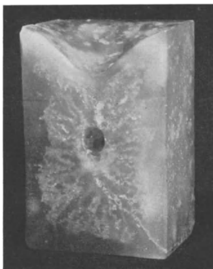
Bild 21. Paraffin-Versuchskörper, der das starke Schwinden und die Hohlraum- und Rissebildung des Paraffins veranschaulicht (bei Abkühlung von 120° auf 20° C).
