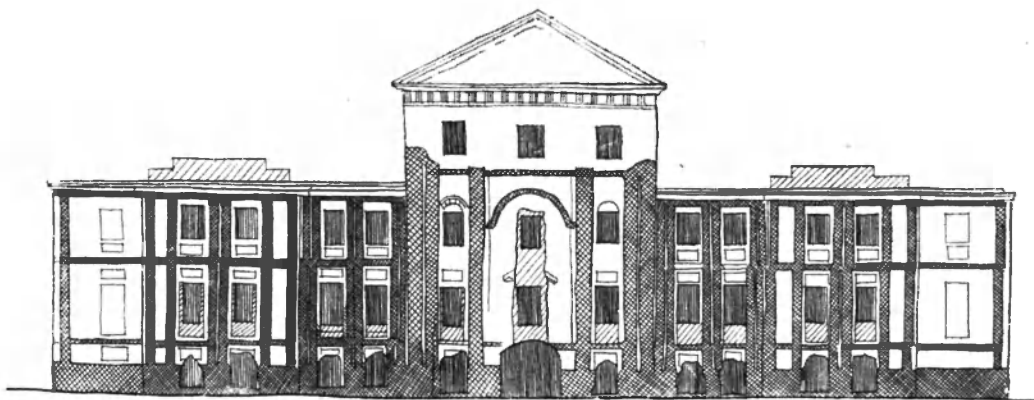
99. Ленинград. Кикины палаты. Раскрытие фасада с выявлением срубленных архитектурных элементов
