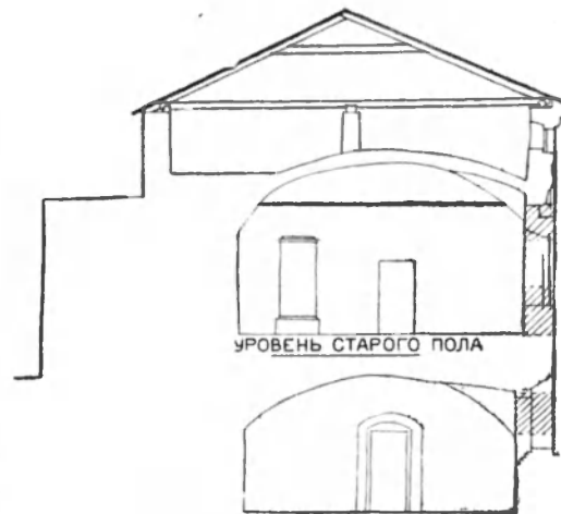
59. Новгород. Архиепископский дворец. Поперечный разрез с показом первоначальных перекрытий помещений
