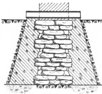
127. Значительное уширение фундамента железобетонными прикладками и разгрузочной железной балкой
