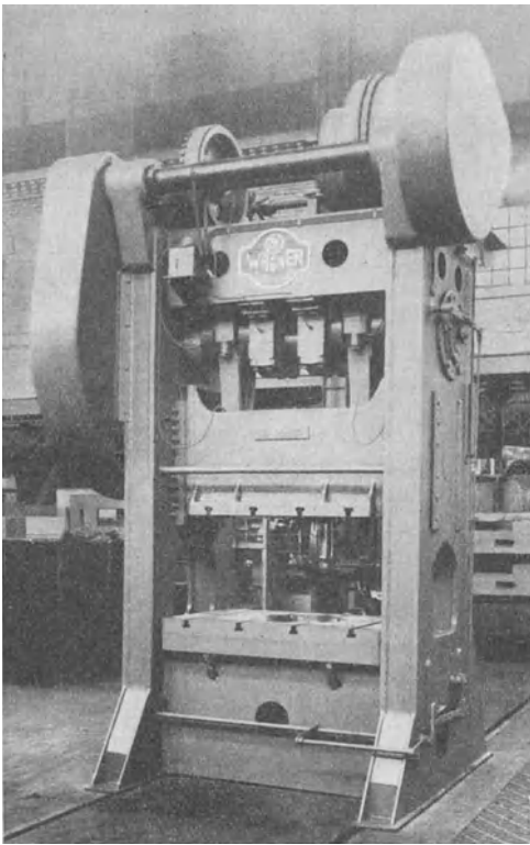
Abb. 115. Pressenständer in Schweißkonstruktion (Wagner & Co.).
