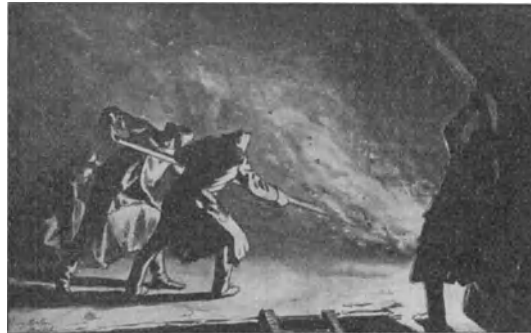
Fig. 2. Umrühren des glühenden Erzes.
