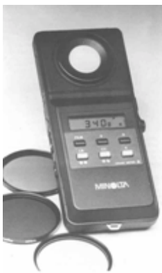
Измеритель цветовой температуры и набор фильтров, используемых для коррекции при обычных условиях освещения
