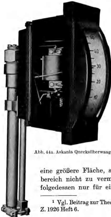
Abb. 44a. Askania Quecksilberwaage.
