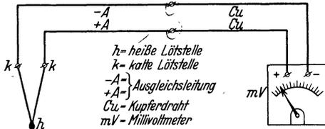
Abb. 54. Thermoelement (schematisch).
