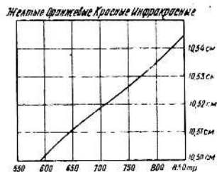
Рис. 13. Фокусные расстояния объектива Фохтлендера F = 10,5 см для различных длин волн
