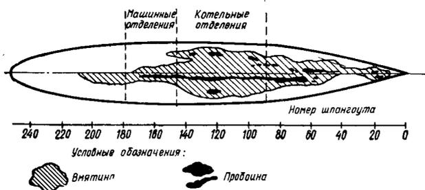
Рис. 1.5. Схема повреждений днища броненосного крейсера «Рюрик»
