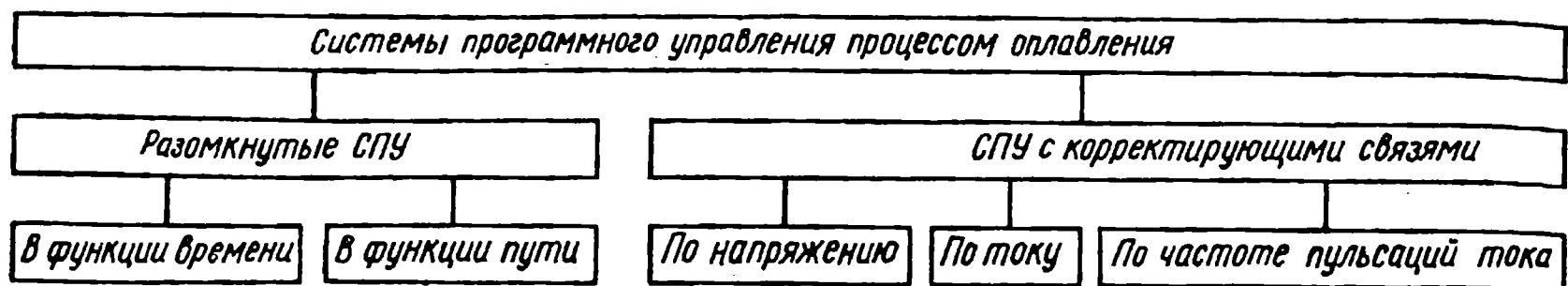
Рис. 5.36. Классификация систем программного управления процессом оплавления
