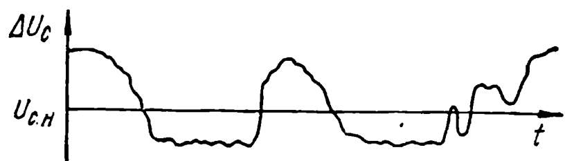
Рис. 1.4. Отклонения напряжения сети U_c от номинального U_{c,н} в течение рабочей смены
